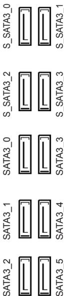
這十組 SATA3 接頭皆支援內部儲存裝置的 SATA 資料纜線，最高可達 6.0 Gb/s 資料傳輸率。若連接背後 I/O 上的 eSATA 連接埠，內部 S\_SATA3\_3 將不會作用。如果已佔用 Ultra M.2 插槽，內部 S\_SATA3\_2 將無法作用。
