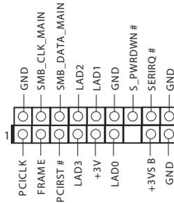
此接頭支援信賴平台模組 (TPM) 系統，可確保儲存金鑰、數位憑證、密碼及資料的安全。TPM 系統也能強化網路安全、保護數位身分並確定平台完整性。
